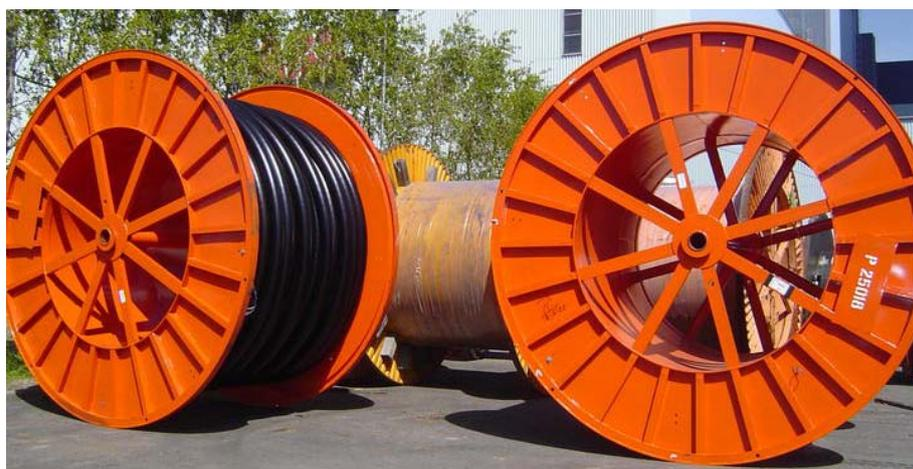
Figura 2-40 Bobinas de Cable Media Tensión
